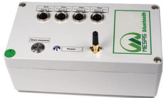
Die Übertragung der Messwerte von der Tasterbox zum Messrechner erfolgt **ohne Kabelanbindung über Bluetooth Strecke.**
