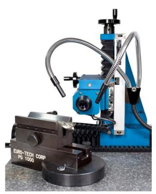
Durch den Einsatz einer reflexionsfreien 5-Mega-Pixel-Farbkamera und einer bis zu 145-fachen Vergrößerung sieht der Prüfer die Teile am Bildschirm in exzellenter Qualität. Messungen sind über das Anfahren von Bildschirmpositionen, über manuellen Vergleich mit Linearmaßstäben sowie über die digitalisierte, automatische Kantenerkennung möglich.
